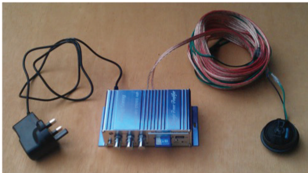
Fot. 123. Najprostszy zestaw do wabienia akustycznego jerzyków, składający się z odtwarzacza mp3 ze wzmacniaczem, zasilacza i głośnika samochodowego (DN).
