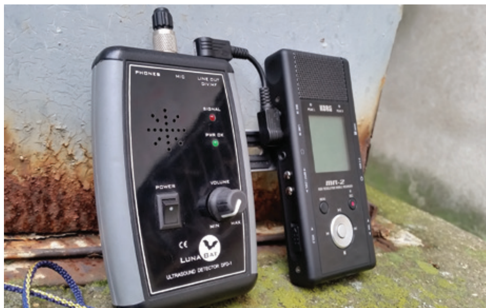
Fot. 23. Detektor ultradźwiękowy pracujący w systemach frequency division oraz full spectrum, połączony z rejestratorem nagrywającym do plików wave z próbkowaniem 192 kHz (DZ).
