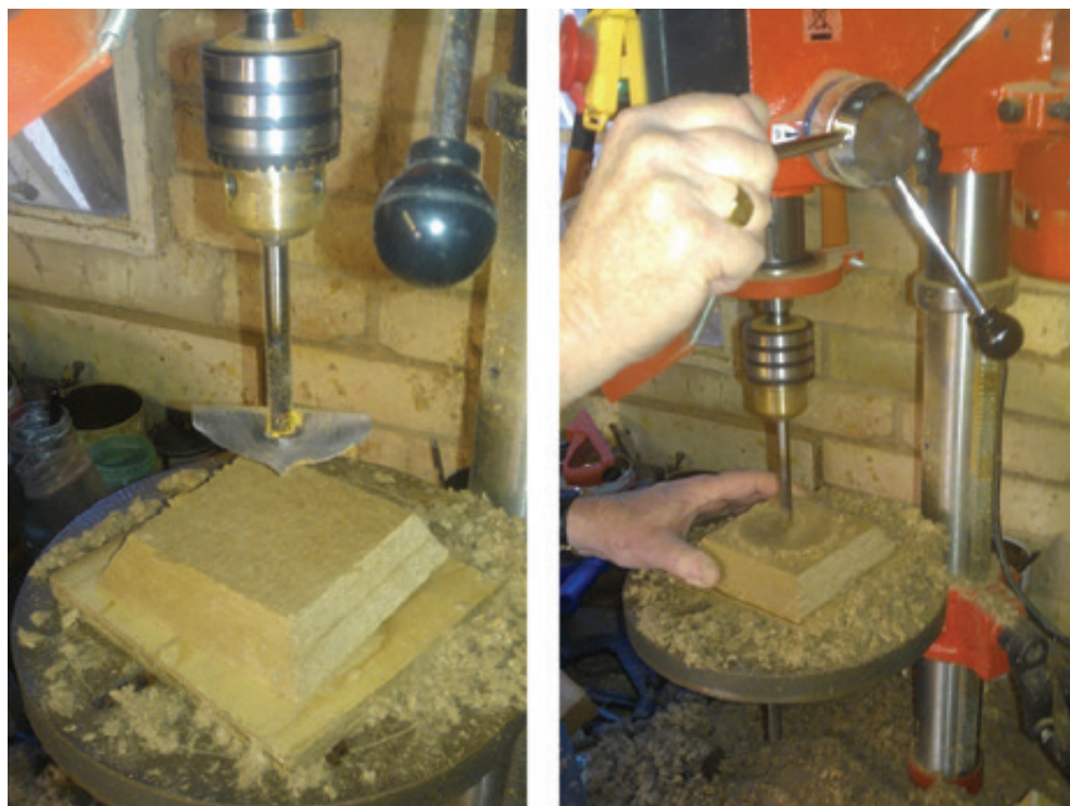
Fot. 125. Sposób wykonania niecki z płyty pilśniowej (DN).
