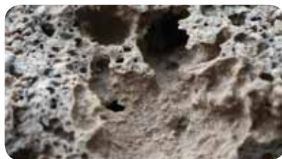
ATONIT produkt przeróbki eternitu w reaktorze mikrofalowym technologia MTT
