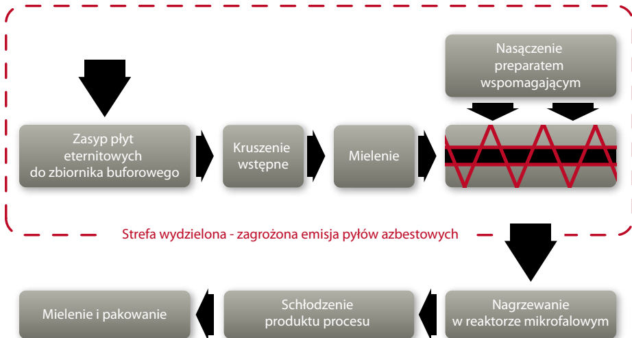
Rys.1. Schemat blokowy instalacji do termicznej utylizacji odpadów zawierających azbest.
