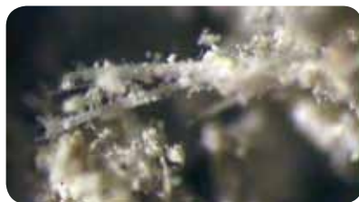
Włókna azbestowe w rozkruszonym eternicie
